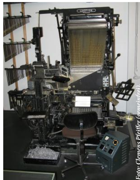
Setzmaschine Linotype, Baujahr 1965.
